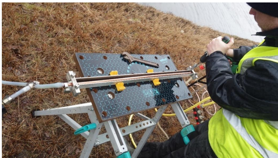
Figuur 2.1 Het afklemmen van de koperen buizen waarin het grondwatermonster voor de bepaling van ^3\text{He} onder druk is opgeslagen
