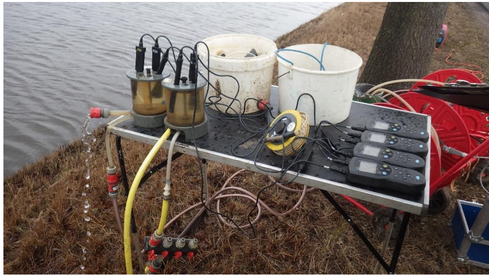
Figuur 2.2 Het meten van pH, zuurstof, EGV en temperatuur (in een doorstroomcel) en TDG (in-situ) tijdens afpompen en bemonstering van een grondwaterfilter.
